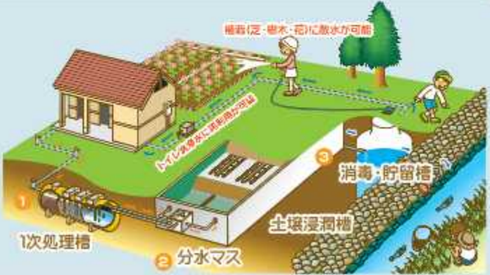
◀ トイレ建屋と一次処理槽(手前)、土壌浸潤槽(右側)
